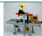
**120a** Macchina semiautomatica; nastratura inferiore e superiore; dimensionamento manuale del formato; doppie cinghie di trascinamento laterali.
