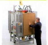
**800rf** Macchina completamente automatica per formati variabili e misti; singolarizzazione dei cartoni; chiusura delle falde superiori; nastratura inferiore e superiore; cinghie laterali di trascinamento; programmazione funzioni con PLC. Comprensiva di separatore-alimentatore 800rf-in. Il modello può essere definito secondo le esigenze del cliente e completato con ulteriori accessori.
